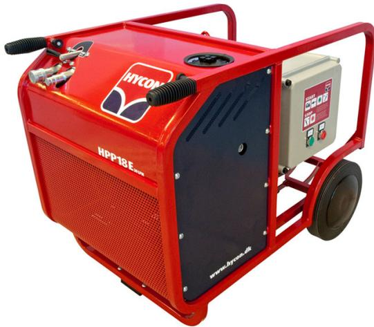
Encendido eléctrico. Las centrales hidráulicas Hycon se utilizan como fuente de alimentación de herramientas hidráulicas como cortadoras, perforadoras, martillos demoledores y bombas. Posee un ajuste del caudal infinitamente variable de 0 a 40 litros por minuto. Es extremadamente popular entre los usuarios de herramientas de alto rendimiento con diamante para perforar y cortar cemento. Liviana.
