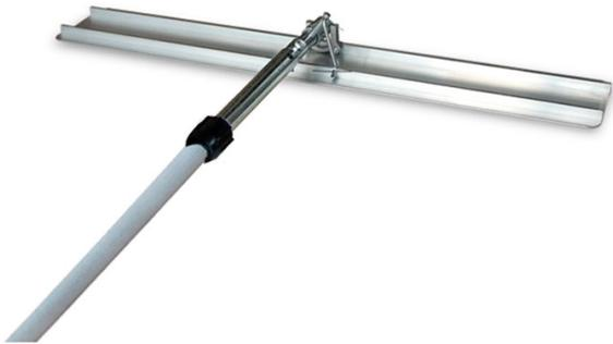
Fratacho fabricado en aleación de aluminio para una vida útil prolongada. Las esquinas de la hoja están redondeadas para no dejar marcas. La inclinación de la hoja es ajustable y controlada mediante la rotación del mango. Esto permite variar la inclinación de la hoja para lograr el acabado óptimo para el hormigón. Si la hoja queda plana sobre la losa deja un acabado rugoso.
