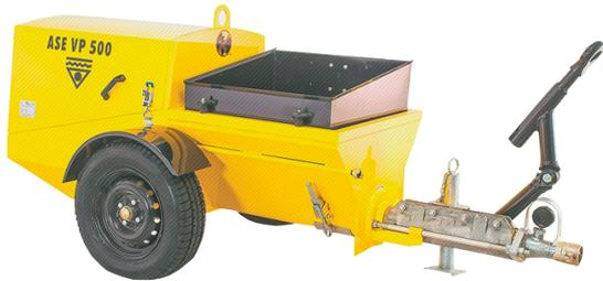
La ASE VP 500 K es ideal para transferir materiales a distancias más altas y más largas con mayor capacidad de bombeo. Es una máquina de alto rendimiento para la transferencia de cualquier mortero húmedo premezclado bombeable de distribución de gránulos de 0-8 mm a base de cemento proveniente de la planta o mezclado en el sitio.
